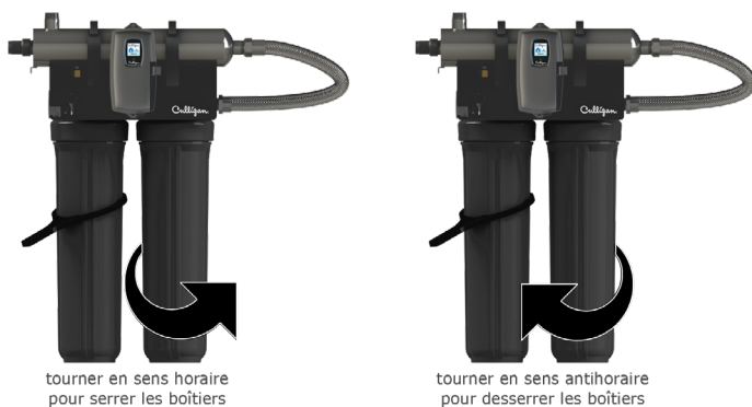
Figure 5. Retrait des cartouches de filtre
