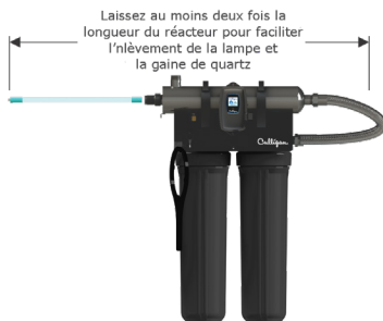
Figure 3. Espace requis pour l'enlèvement de la lampe
