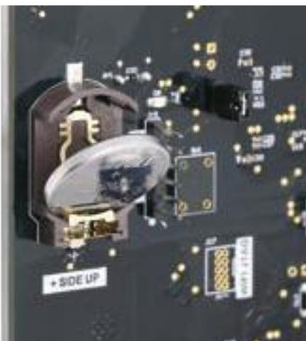
Insérez la pile bouton CR2032, avec le côté positif de la pile orienté vers l'extérieur, dans la fente vide de la carte de circuits imprimés GBX.
