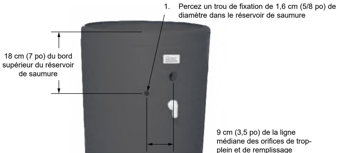
Figure 88. Hauteur du flotteur de la vanne de saumure.
